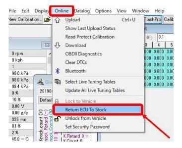
④ 「Yes」をクリックして、まず車両側の ECU を純正に戻します。( $5\sim10$  分掛かります。)
