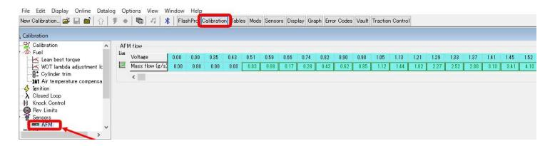
® Air flow meter 電圧(AFMv) 0.98~1.13v の Mass flow 数値を選択し、右クリック。
