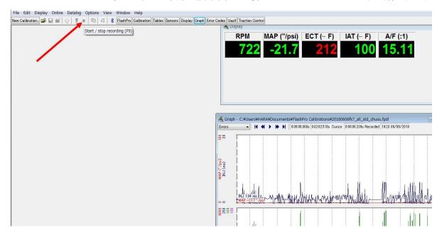
II 、 もう一度 F9 キーもしくは下記の赤丸ボタンを押すとレコードが終了しますので<Datalog>タブの<Save as>をクリックし、保存して下さい。
