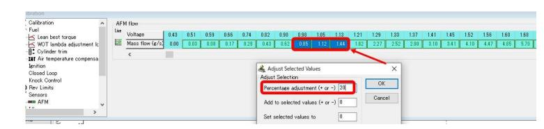
⑨ Air flow meter 電圧(AFMv)1.21~3.01v の Mass flow 数値を選択し、右クリック。
