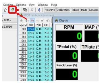
④左記矢印のボタンをクリックし、黄色に点灯すると車両 ECU と通信が開始し、各センサーの数値が表示されます。
