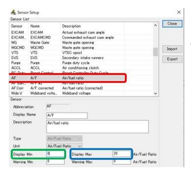
「Sensor Setup」画面で、センサーを選択し、「Display Min」にセンサーの最小値を入力。
