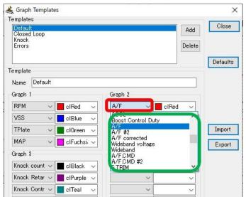
例)Graph 2 を選択し、緑枠の中から[A/F]センサーを 選択します。
