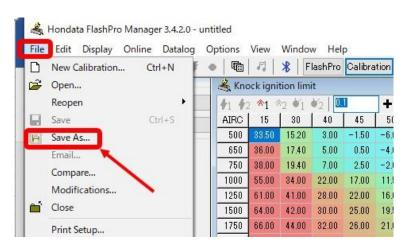
②画面左上の〈File〉をクリックし、〈Save As〉をクリックすると、ソフトウェアインストール時に作成した「FlashPro Calibrations」フォルダが開きますので、名前を付けて保存します。
