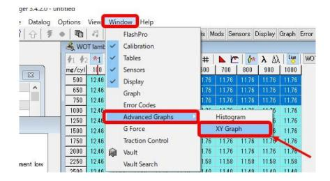
④ XY グラフを開き、X 軸には'AFM.v'を、Y 軸には'S.TRIM'を選択します。「Show Mean」にチェックを入れ平均値を表示します。「Closed Loop」にチェックを入れ、「Open Loop」、「WOT」のチェックを外します。現在グラフに表示されているのは、AFM の読み取り値と、ECU がどれだけ燃料を補給する必要があるかというグラフです。
