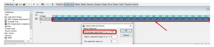
⑩全域で調整が完了したら、車両側 ECU にアップロードします。
